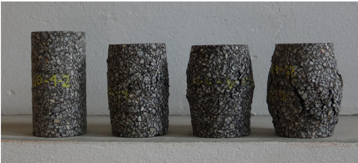
Abbildung 16: Temperaturabhängiges Verformungsverhalten der Probekörper
